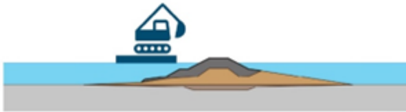
Stap 1c: In aantal ophoogslagen voorbelasting aanbrengen.
