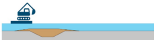
Stap 3: Het cunet wordt gevuld met zand
