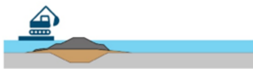
Stap 2: Het vrijgekomen holoceen materiaal kan gebruikt worden om het grondlichaam op te bouwen. Het materiaal moet rusten in een tijdelijk depot
