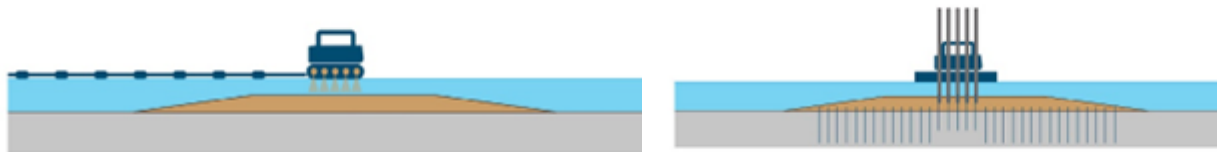
Stap 1: Aanbrengen basis zandlaag.
